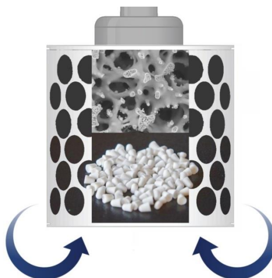
Rys. 2. Schemat reaktora rotacyjnego typu SpinChem® wraz z ziarnami katalizatora.
